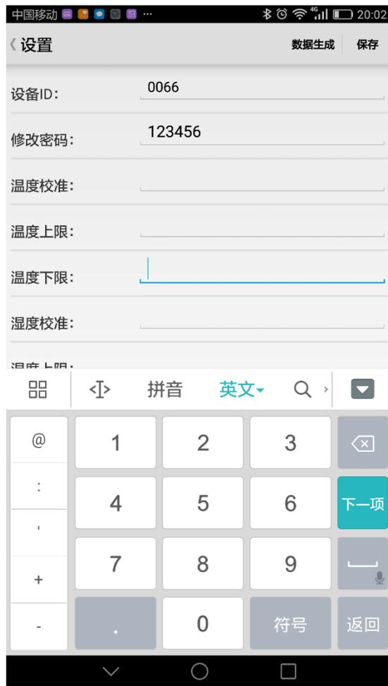
首先设置 ID 号。其次设置好温度上限，温度下限，湿度上限，湿度下限。点击保存，此时，手机和云服务器已经连接成功，打开电脑端温湿度监测软件，冷链区可显示冷链设备的实时温湿度。
